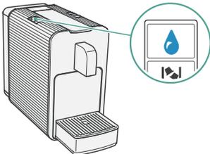
Der Wassertank ist mit einem Wasserstandssensor ausgestattet, der die Kaffeeausgabe bei leerem Tank automatisch stoppt.
