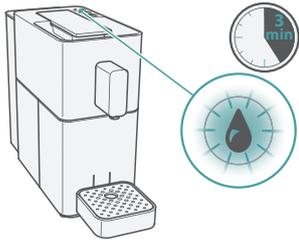
Wenn die Maschine nicht benutzt wird, wechselt sie in den Energiesparbetrieb.
